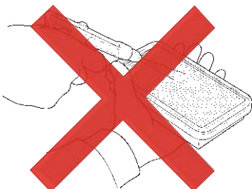
滤芯禁止用压缩空气吹尘
