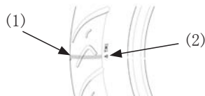
(1) 磨损标记 (2) 磨损位置指示标记
